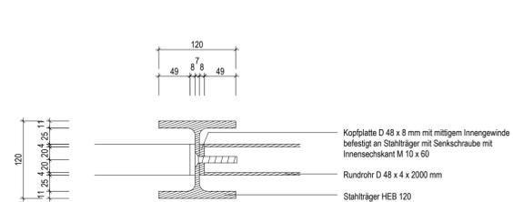
Detail 4: Draufsicht Verbindung Rundrohr (M 1 : 5)
