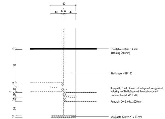
Alle Stahlteile feuerverzinkt und beschichtet DB703.
