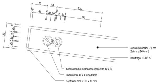
Detail 3: Frontansicht Verbindung Rundrohr (M 1 : 5)
