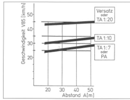
Bild 94: Geschwindigkeitsniveau  $V_{85}$  in Abhängigkeit von Art (TA = Teilaufplasterung, PA = Plateaufplasterung) und Abstand baulicher Maßnahmen
