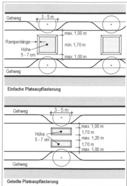
Bild 95: Abmessungen von Plateaufplasterungen
