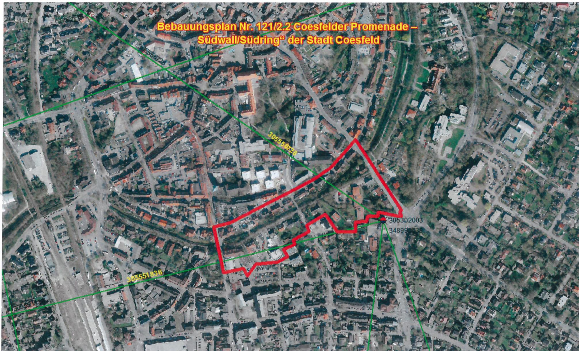
Die farbigen Linien verstehen sich als Punkt-zu-Punkt-Richtfunkverbindungen der Telefonica Germany GmbH & Co. OHG. Das Plangebiet ist im Bild mit einer dicken roten Linie eingezeichnet.
