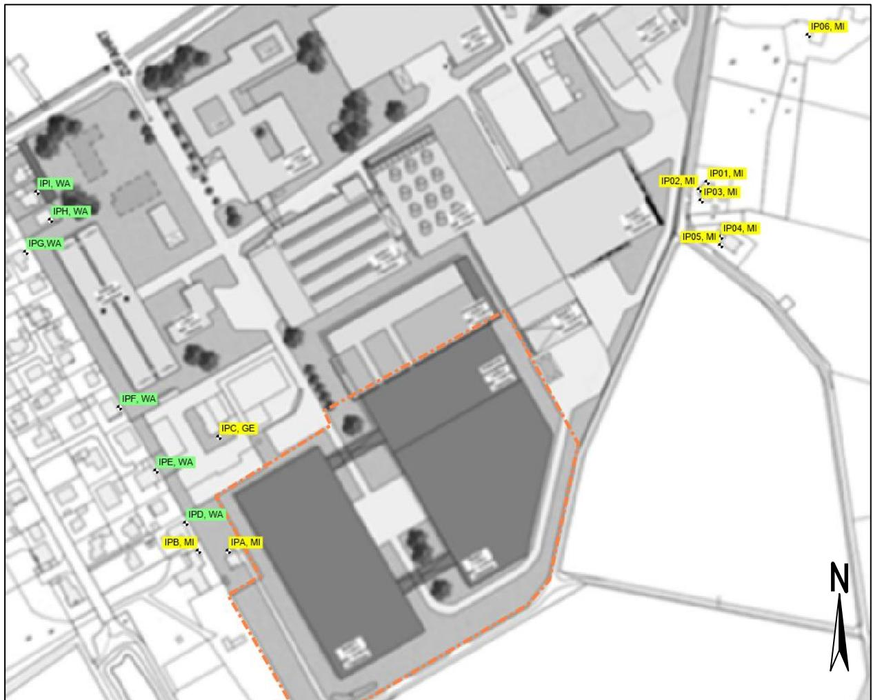
Abbildung 4: Lage der im Rahmen der Schallimmissionsprognose betrachteten Immissionsorte), Quelle Architekturbüro Wortmann
