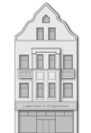
► Problematischer Umbau: Kragplatten mit überdimen- sionierter Werbung
