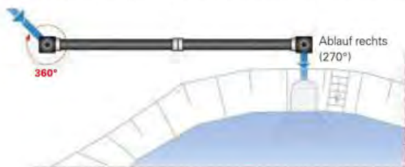
Anwendungsbeispiel 1: SediPipe level 600/12 (600/6) mit Ableitung in ein oberirdisches Gewässer oder in den Kanal *variabel, abhängig von Schachtabdeckung sowie Höhe und Anzahl der Auflageringe
