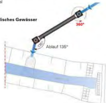
Anwendungsbeispiel 1: SediPipe level 600/12 (600/6) mit Ableitung in ein oberirdisches Gewässer oder in den Kanal *variabel, abhängig von Schachtabdeckung sowie Höhe und Anzahl der Auflageringe
