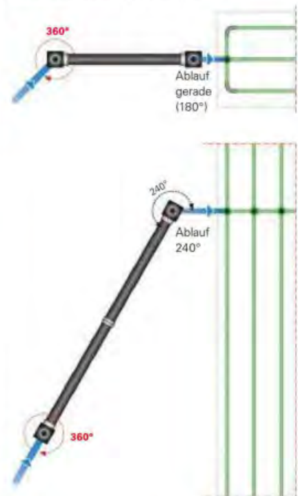
Anwendungsbeispiel 2: SediPipe level mit nachgeschalteter SickuPipe-Rohrriogle, Verbindungsleitung DN 200 an schwenkbarem Zulauf von SickuControl
