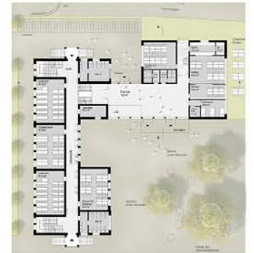
Grundriss Erdgeschoss M 1:200
