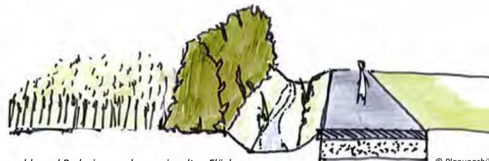
Ausbau einer Sickermulde und Reduzierung der versiegelten Fläche
