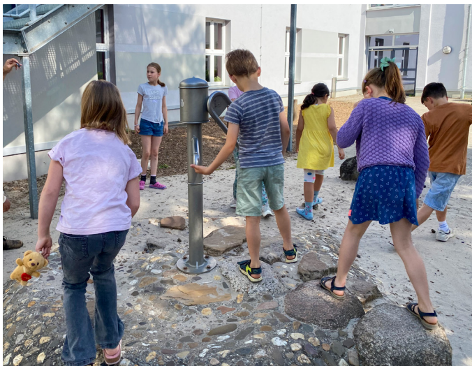
Wasserpumpe – ein Highlight für die Kinder, jedoch häufig außer Betrieb, da durch Matsch ein hoher Schmutzeintrag ins Gebäude erfolgt.
