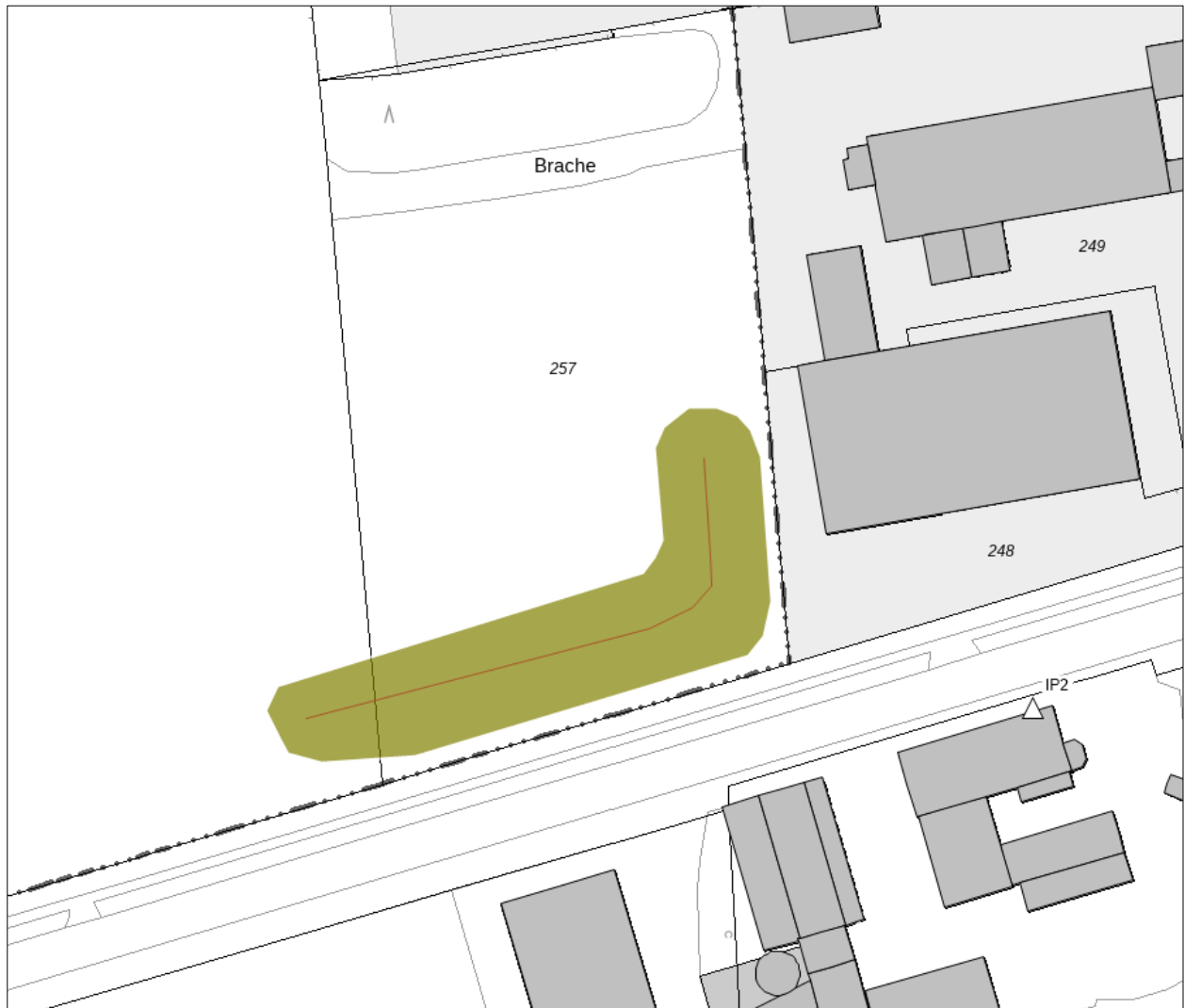
Abbildung 5: Darstellung einer potenziellen aktiven Lärminderungsmaßnahme (Bsp. Lärmschutzwall)
