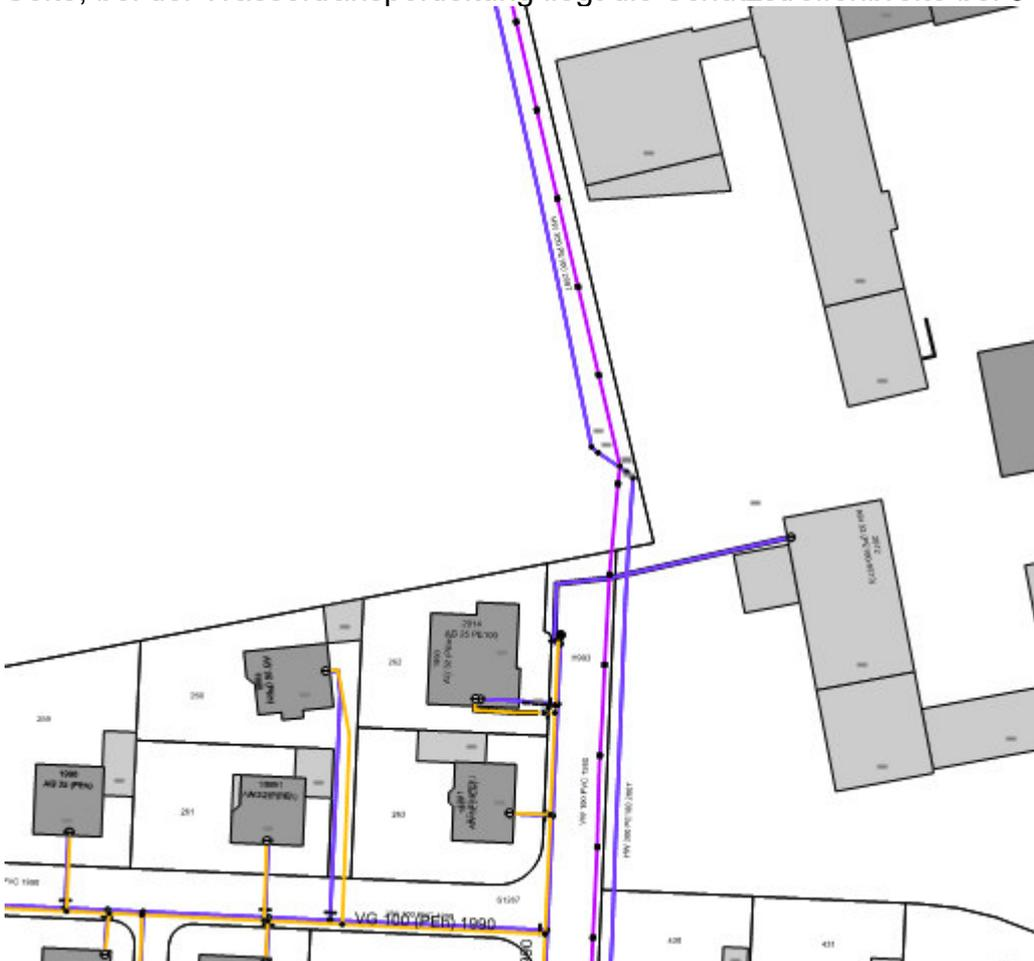
Eine Bereitsstellung für Trinkwasser zu Feuerlöschzwecken gemäß dem DVGW Arbeitsblatt W405 kann in Höhe von maximal 96 m³/h im ungestörten Netzzustand über einen Zeitraum von 2 Stunden über die Summe der im Umkreis von 300 m befindlichen Hydranten erfolgen.
