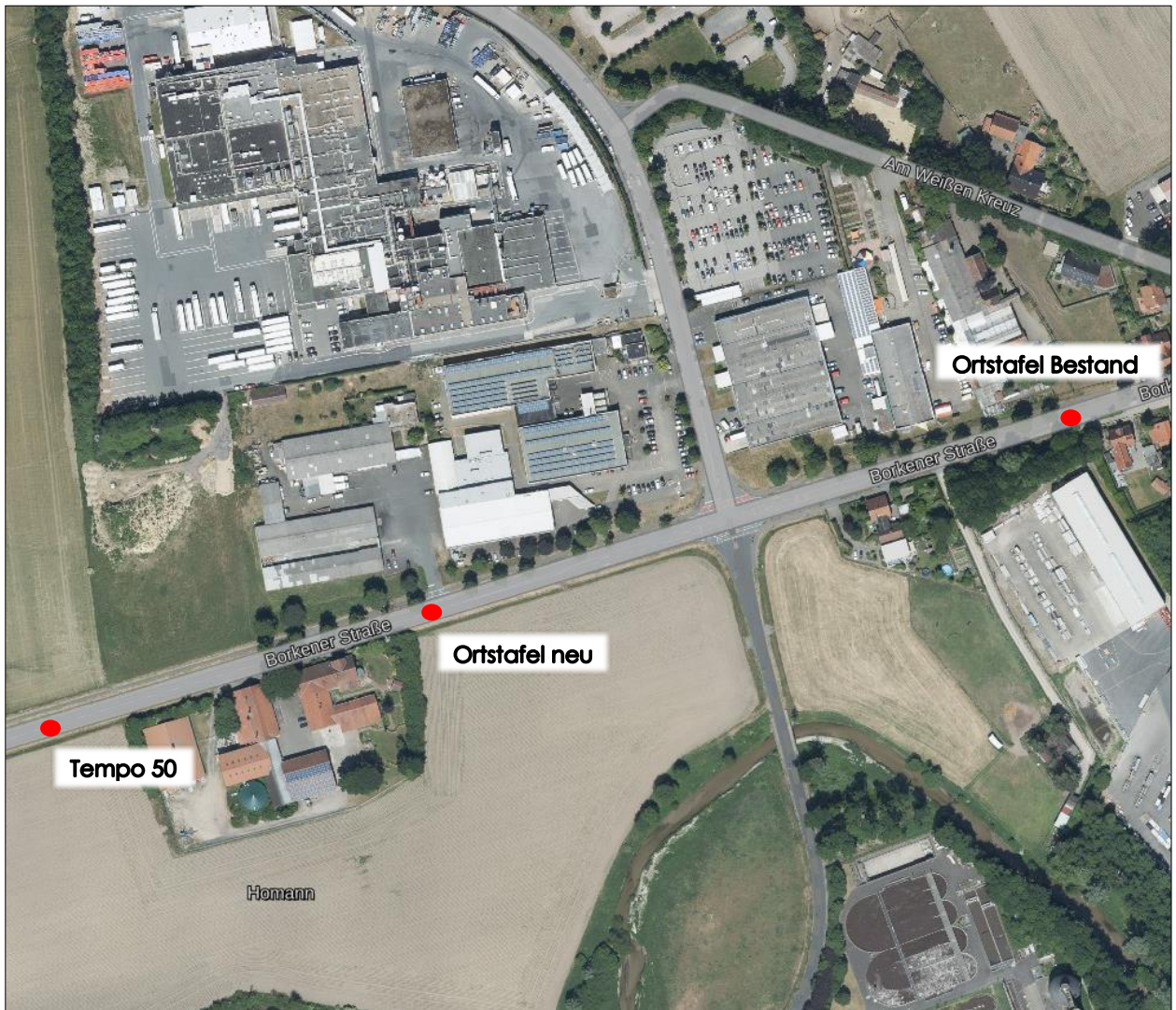
Abbildung 6: Versetzung der Ortstafel und Anordnung Tempo 50 km/h an der Borkener Straße
