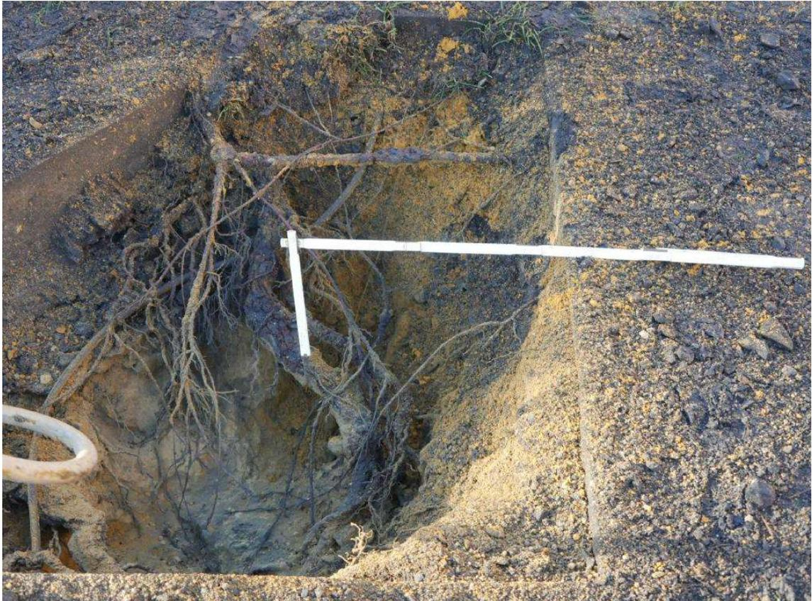
bis hin zu minimaler Durchwurzelung auf Grund einer tieferliegenden Betonschicht
