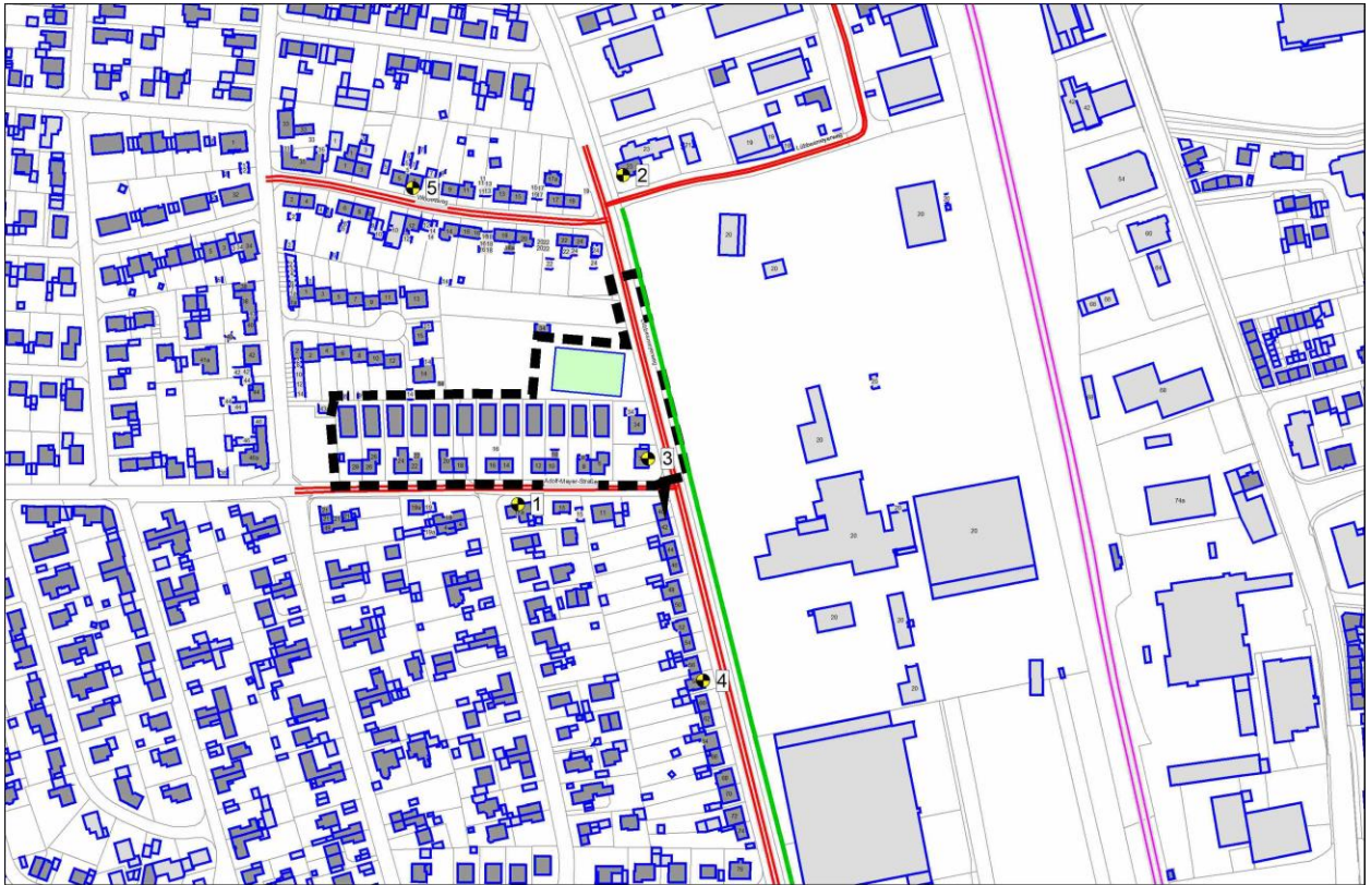
Abbildung 4: Auszug aus dem Berechnungsmodell nach DIN 18005 [11] im Prognose-Planfall
