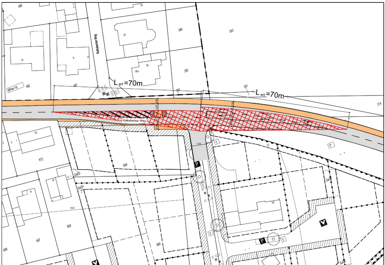
Abbildung 14: Verkehrstechnische Skizze – Überprüfung der Anfahrtsicht
