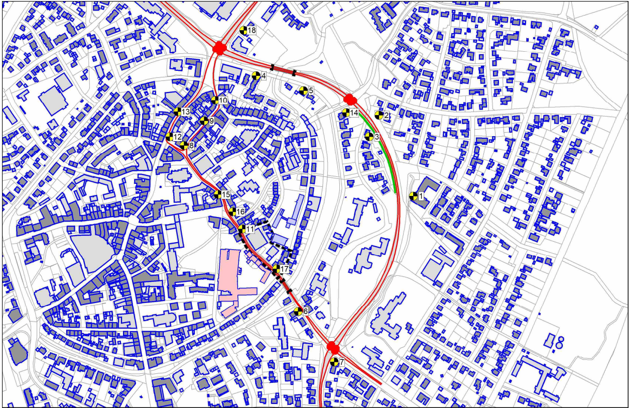
Abbildung 3: Auszug aus dem Berechnungsmodell nach DIN 18005 [8] im Prognose-Planfall
